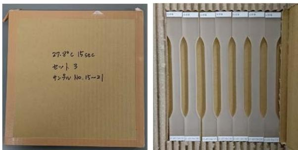
図7 試験片を梱包したダンボールの外観および内部の試験片の状況
