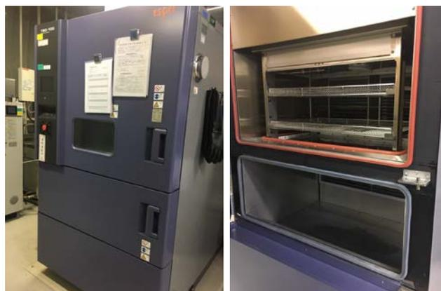
図10 冷熱衝撃試験機 TSD-100 の外観（左）および試験機内部の状況（右）
