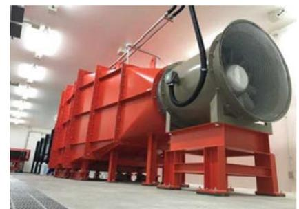
写真 道内唯一の「自然雪風洞実験装置」
