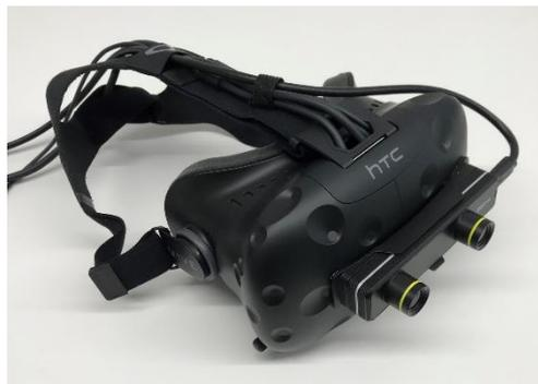
図 11 改良した HMD システムの外観
